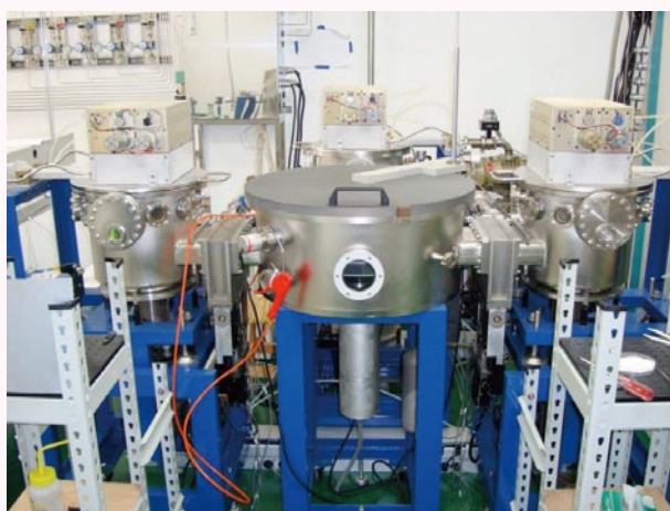
圖一、三腔體雷射輔助電漿增強式化學氣相沈積系統
