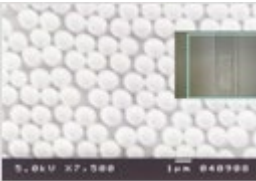
シックハウス症候群の原因物質等を吸着・光分解させるチタニア薄膜上に配列させた多孔性球状シリカ粒子 (三宅義和教授)
